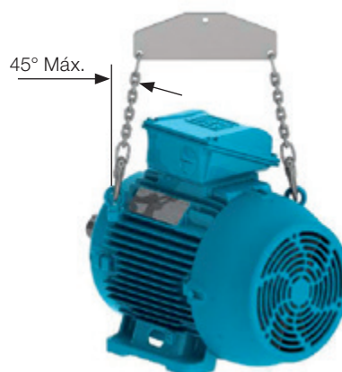
Figura 4.4 - Angolo massimo risultante per i motori con due o più golfari di sollevamento
