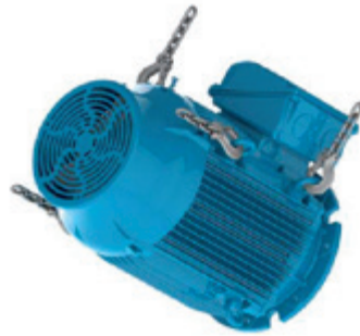
Figura 4.18 - Il motore viene ruotato in posizione orizzontale
