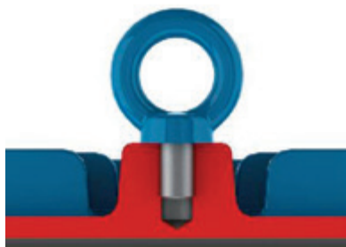
Figura 4.1 - Maniera corretta di fissaggio del golfari di sollevamento
