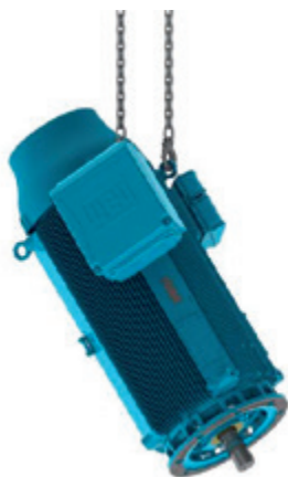
Figura 4.14 - Sollevamento dei motori HGF e W50 tramite i golfari di sollevamento posteriori
