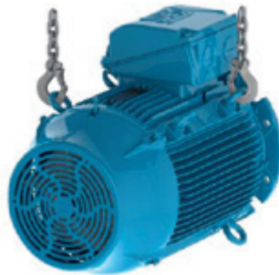
Figura 4.19 - Risultato finale: motore posizionato orizzontalmente
