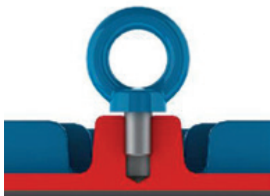
Figura 4.2 - Maniera sbagliata di fissaggio del golfari di sollevamento
