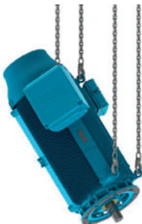
Figura 4.13 - Sistemazione di motori HGF e W50 verticalmente
